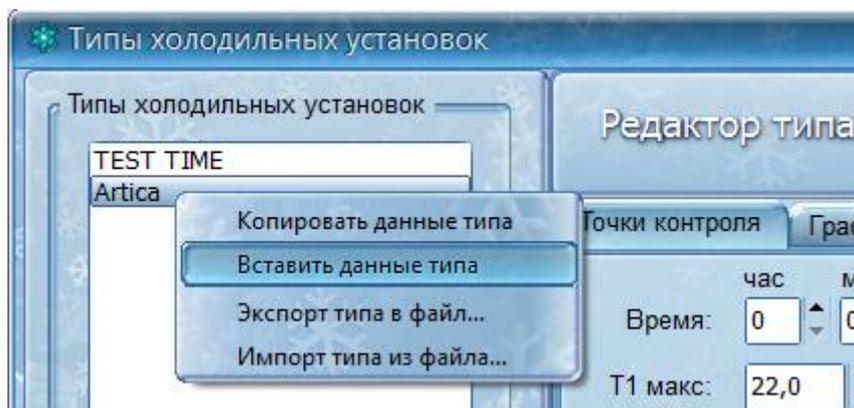
Так же следует отметить возможность экспорта типа в отдельный файл (например, для отправки по электронной почте или переноса на другое рабочее место) и импорта типа из внешнего файла. Эти функции реализованы в пунктах контекстного меню «Экспорт типа в файл...» и «Импорт типа из файла...».
