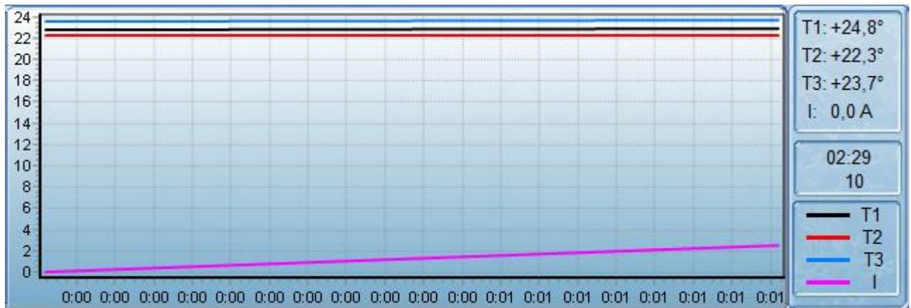
Основную часть развёрнутой панели занимает график тестирования в реальном масштабе времени. На графике показаны все контролируемые параметры, минимумы и максимумы точек тестирования в виде небольших треугольников.
