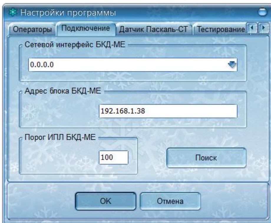
Блок БКД-МЕ подключается к локальной сети через интерфейс ETHERNET. Если компьютер имеет несколько сетевых интерфейсов, то укажите в поле выбора «Сетевой интерфейс БКД-МЕ» через какой сетевой интерфейс выполнять работу с блоком БКД-МЕ. В большинстве случаев можно оставить сетевой интерфейс «0.0.0.0».
