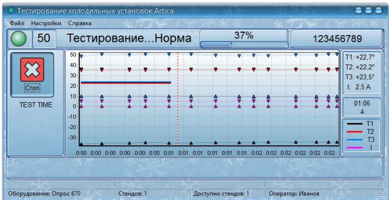
Следует обратить внимание, что на панели стенда изменились элементы управления, теперь доступна кнопка "Стоп". Ниже кнопки показан выбранный тип холодильной установки, по которому сейчас проводится тестирование.
