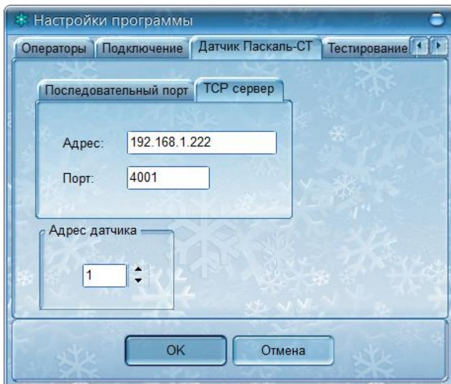
Кроме этого, следует задать адрес датчика в линии RS-485. Если адрес датчика неизвестен, задайте нулевое значение адреса.
